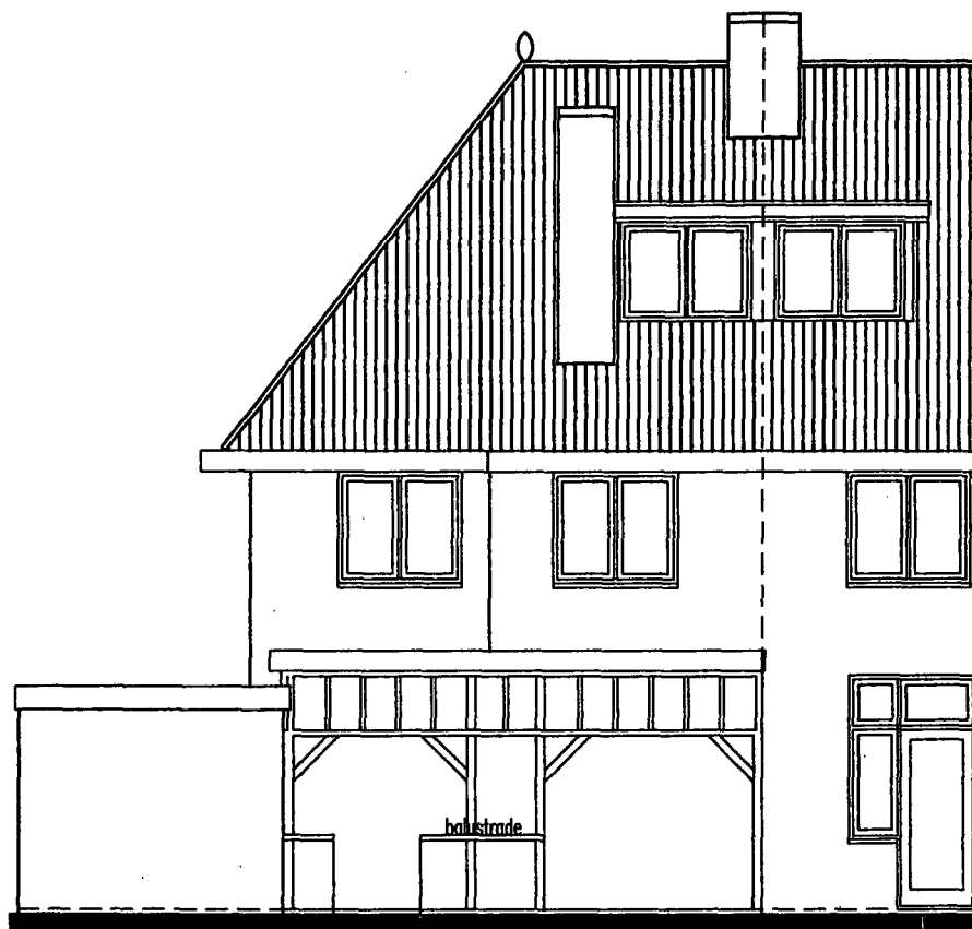
ACHTERGEVEL met bestaande open veranda welke deels zal worden gesloopt
